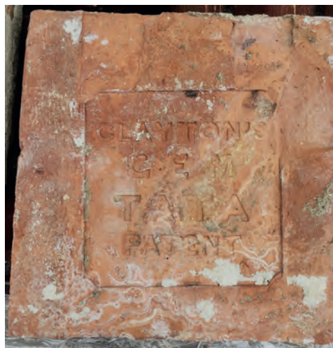
3. kép. Burkolótégla beütött CLAYTON / GEM / TATA / PATENT felirattal Gróf Esterházy II. Miklós téglagyárából, ahol a megvásárolt Clayton Patent márkanevű skót téglagyártó gépet alkalmazták. 16 Fotó: Hajtó Kornélia, 2017
